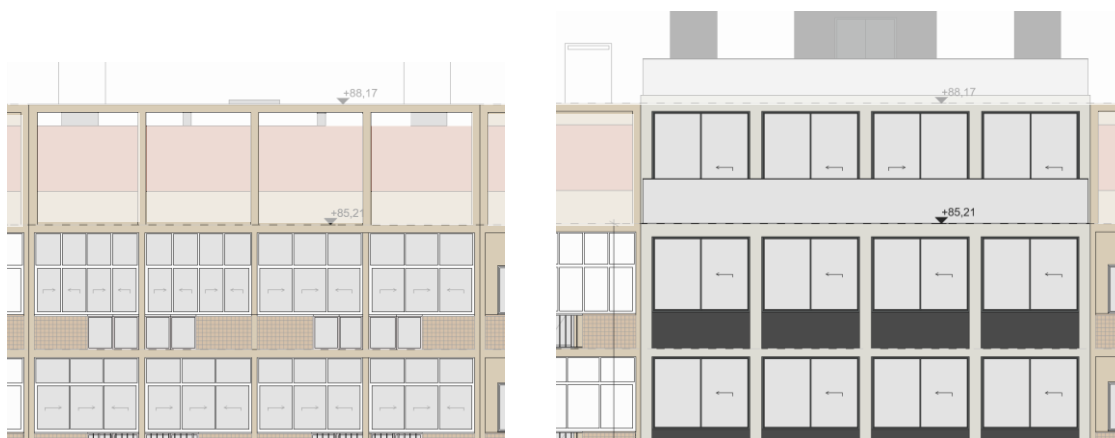
Figura 6 – Ampliação da cobertura - implicações no alçado principal
